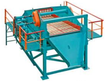
SUSUZLANDIRMA ELEĞİ / Dewatering Screen
